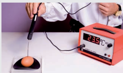
Figure 3a. Nous avons commencé par prendre la température de l'œuf en y insérant une fine sonde thermique à travers un petit trou réalisé dans la coquille de l'œuf.
