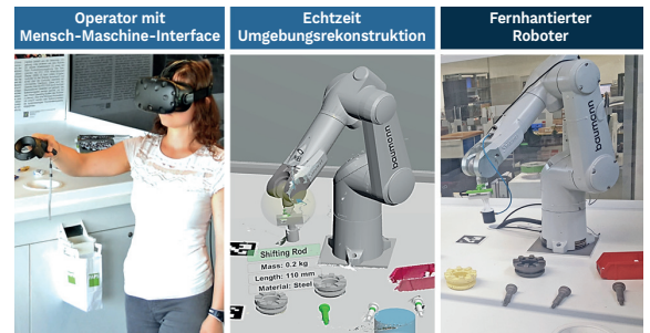
Konzept der roboterassistierten Sortierzelle mittels VR/AR-Fernhandlung (Versuchsstand FAPS)
